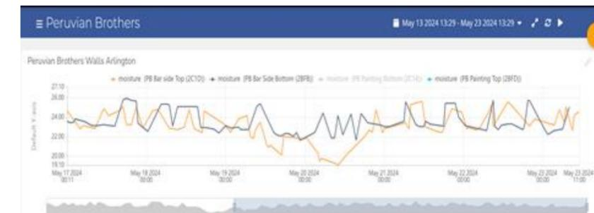
Wassersensoren, um den Wasserspiegel im Honeycomb Leger zu messen. Kabellose Messung des Feuchtigkeitsgrades im Sedum. Abgleich mit Daten der Wetterstation: Windrichtung, -geschwindigkeit, Luftfeuchtigkeit, Sonneneinstrahlung, Temperatur, Niederschlag.
