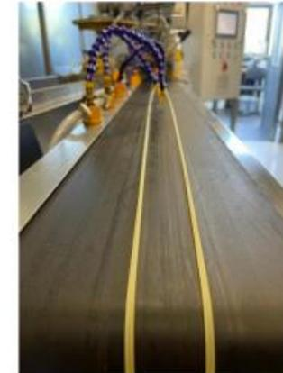
Kühlung mittels Luftdruck
